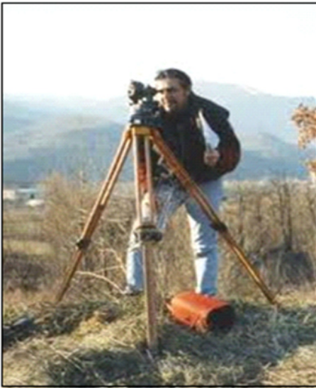
misurazione con il teodolite
